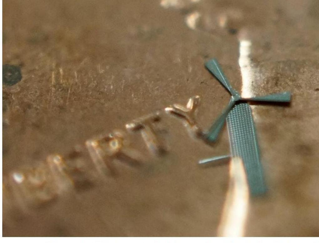
Сотни ветряных мельниц смогут вырабатывать электроэнергию, которой хватит для зарядки, допустим, мобильного устройства или планшета. Для приготовления используют прочный сплав никеля, что даёт гарантию на устойчивость к деформации при сильном порыве ветра и попадании мелких частиц грязи.
